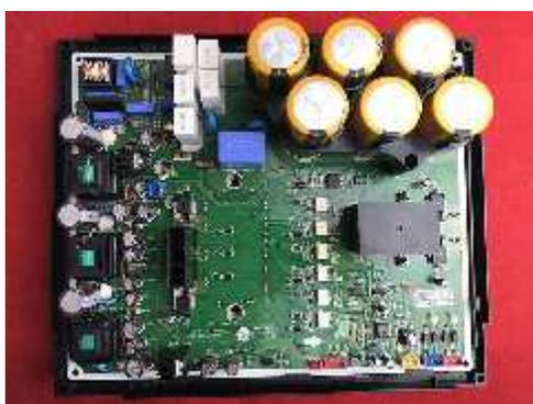
Placa electrónica exterior de aire acondicionado inverter (nótese los capacitores de mayor tamaño)
